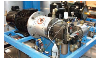
bezobsługowa instalacja pompy dozującej polioliu oraz izocyjanianu w wysokociśnieniowych wtryskarkach PUR
