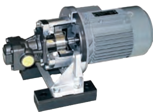
modyfikacja zestawu pompy zębatej; sprzęgło MINEX® SA 75/10, łącznik pompa-silnik PK 200/30, podstawa z listwami tłumiącymi
